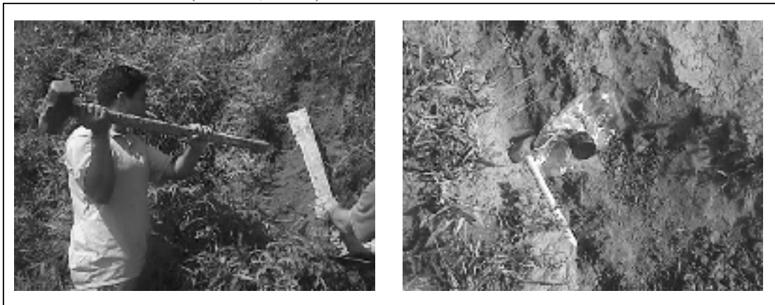
Foto 01 – Técnicas de Coleta de sedimentos para datação por LOE; introdução do Tubo de PVC. (Arruda, 2001)
